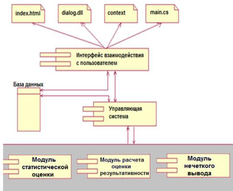
Рисунок 4.1 - Архитектура интеллектуальной автоматизированной системы управления менеджментом качества предприятия
